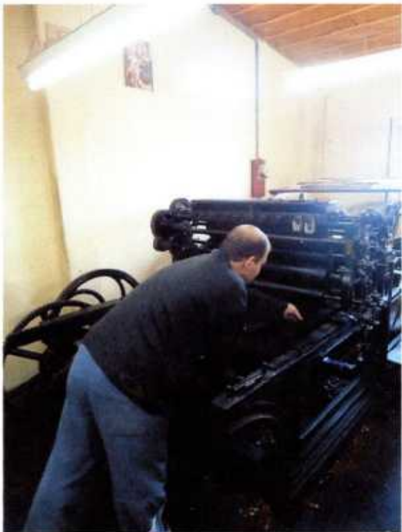
Imagens 7 e 8. O tipógrafo dispõe página composta por tipos móveis na máquina e verifica seu funcionamento (Fotografia: Iphae).
