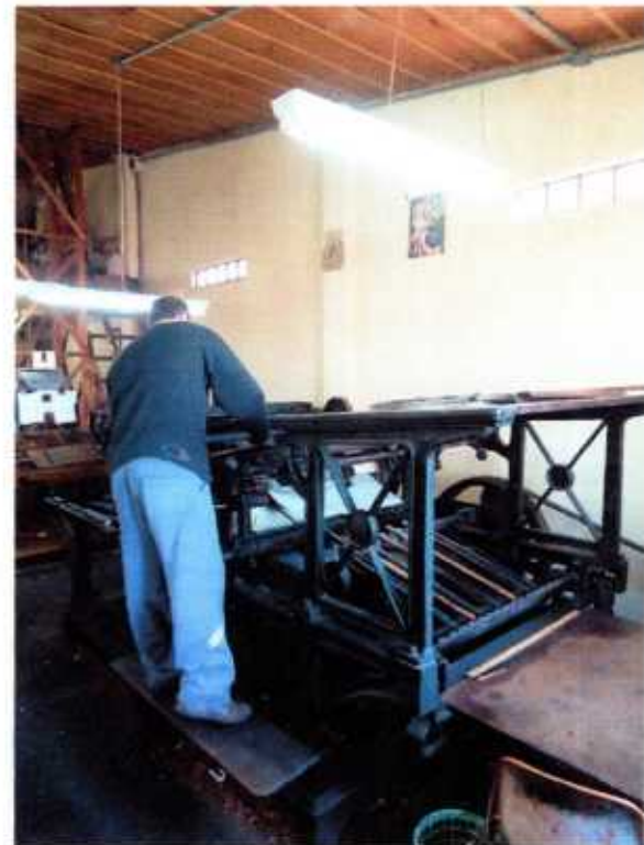
Imagens 7 e 8. O tipógrafo dispõe página composta por tipos móveis na máquina e verifica seu funcionamento (Fotografia: Iphae).
