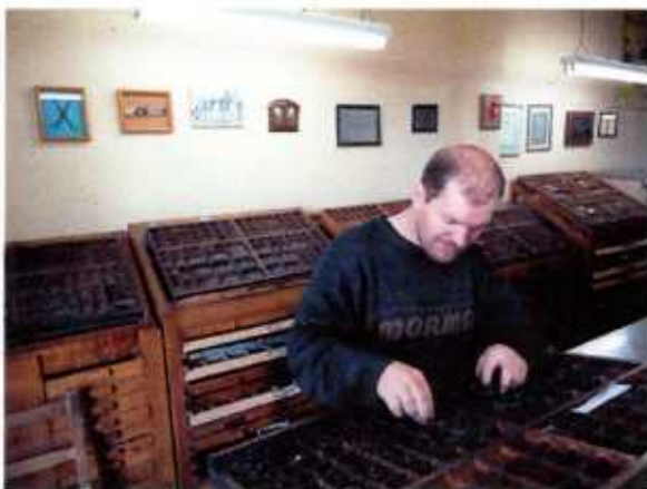
Imagem 1. O tipógrafo João Rodrigues, em frente às caixas de tipos, compondo o texto (Fotografia: Iphae).
