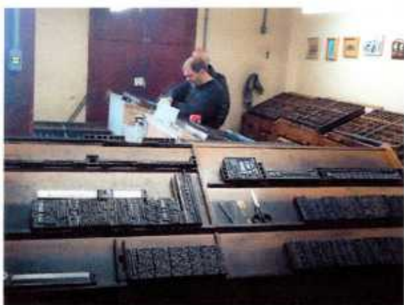
Imagem 3. A “galera”, em primeiro plano, com as composições dispostas em colunas. Ao fundo, o tipógrafo compondo (Fotografia: Iphae).
