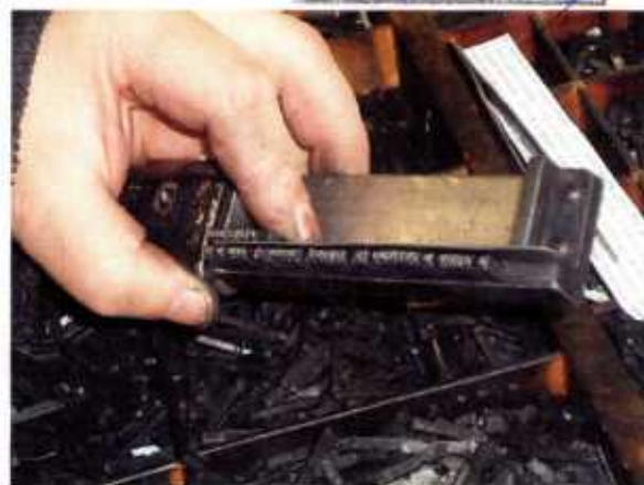
Imagem 2. Uma frase em processo de criação no componedor (Fotografia: Iphae).
