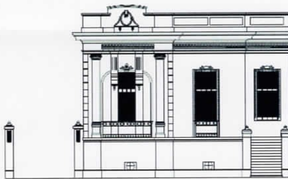
FACHADA PRINCIPAL COM PORÃO ALTO E ACESSO LATERAL
